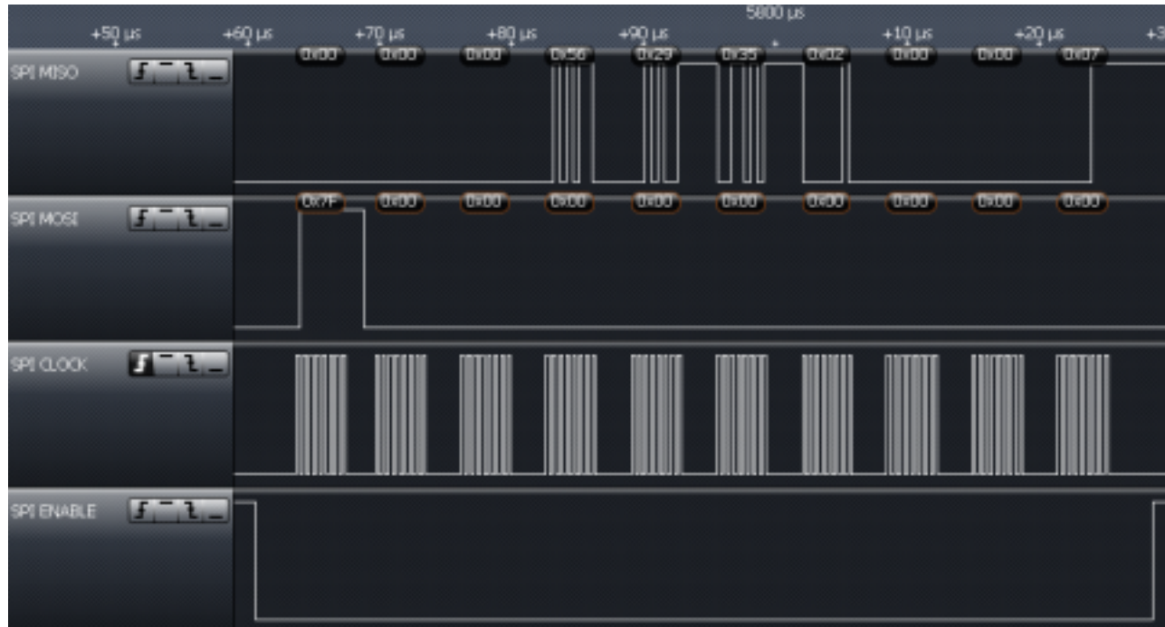
图 5-23. 目录命令之后 FIFO 的持续读操作
