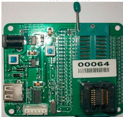
SOP-16转换座的安装
