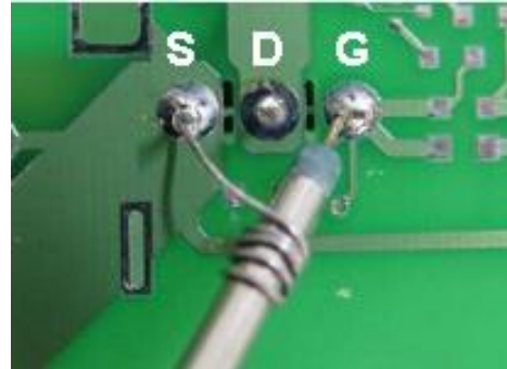
图 37. 去掉探针末端和接地引线后进行的测量
